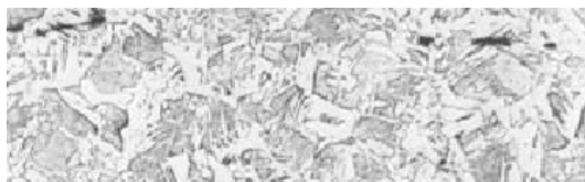
Obr.2: Povrch oceli tvořený bainitem
