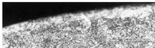
Obr.3: Žebírko tvořené dolním bainitem
