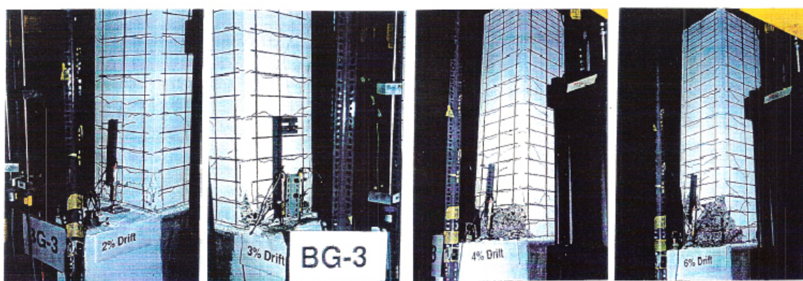
Obr.22: Poškození konstrukce při 2 % , 3 % , 4 % a 6 % příčného vychýlení
