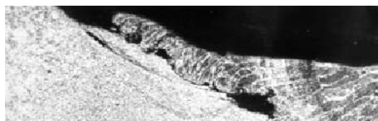
Obr.4: Svar v oblasti žebírka
