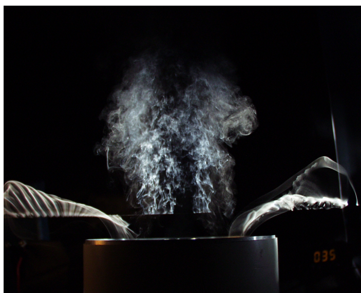
Obr. 2 Vizualizace volného výtoku z trysky ve stavu 1 metodou kouřícího drátu
