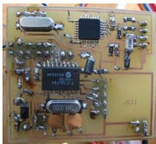
Obr.3 Komunikační jednotka na bazi jednočipového počítače řady PIC
