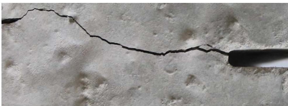
Obr. 7 Ilustrační detail vrubu ve vzorku z cementového kompozitu, vytvořeného diamantovou kotoučovou pilou; trhlina se iniciuje v jednom z vrcholů vrubu a šíří se skrze vzorek.
