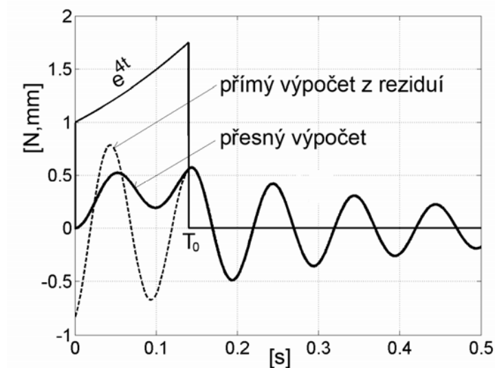
Obr.4 Odezva tlumeného systému 2. řádu na vzestupný exponenciální impuls síly (vytvořující funkce impulsu je \varphi(t) = e^{4t} , m=1\text{kg} , \Omega/2\pi=10\text{Hz} , tlumení \zeta=0,05 )
