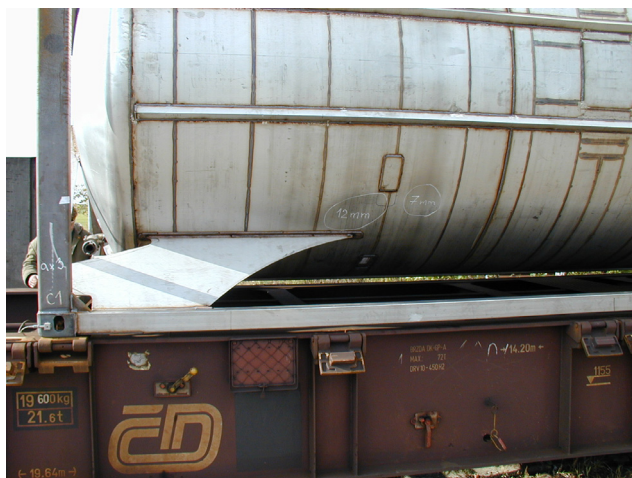
Obr.3 Trvalé deformace po dynamické zkoušce
