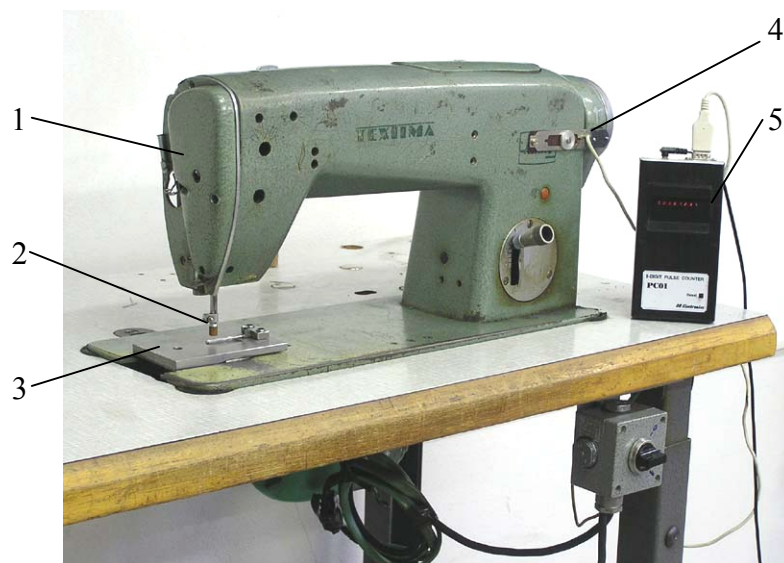
Obr.1 Pracovisko pre skúšku ihiel cyklickým ohybom
