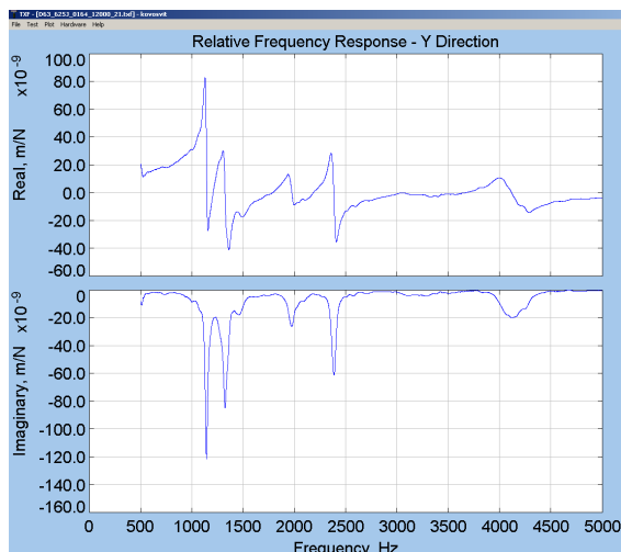
Obr. 13 Přenosy frézovacích nízkootáčkových vřeten s nástroji D63. Nejvyšší vrcholy patří kmitání nástrojů společně s vřetenem a držákem.
