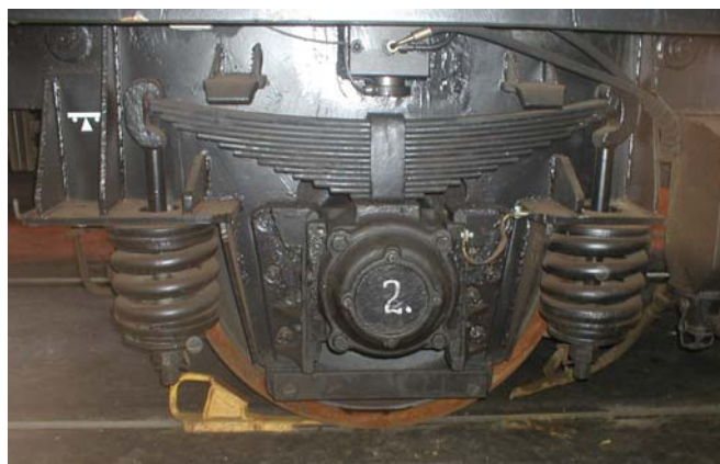
Obr. 6 Rozsochové vedení a vypružení dvojkolí vozidla MPV 22
