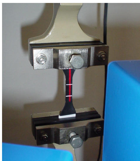
Obr. 3: Pohled na měření vzorku jednoosým tahem
