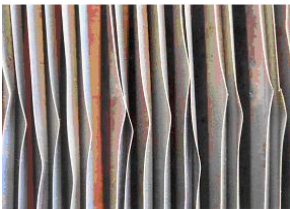
Obr. 6. Globální průhyb a lokální boulení plechů
