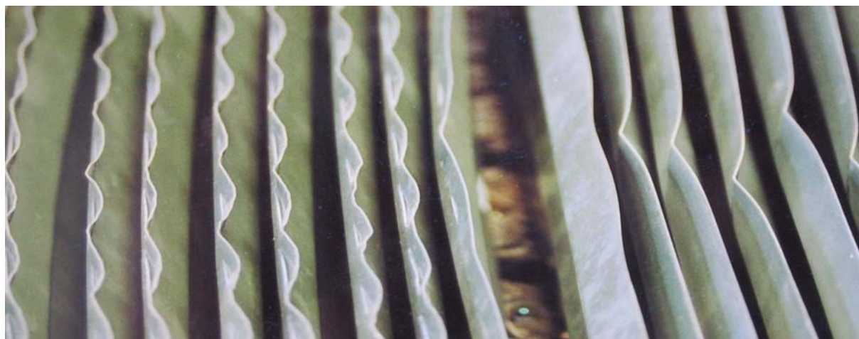
Obr. 7. Deformace jednotlivých typů plechů po simulaci brždění
