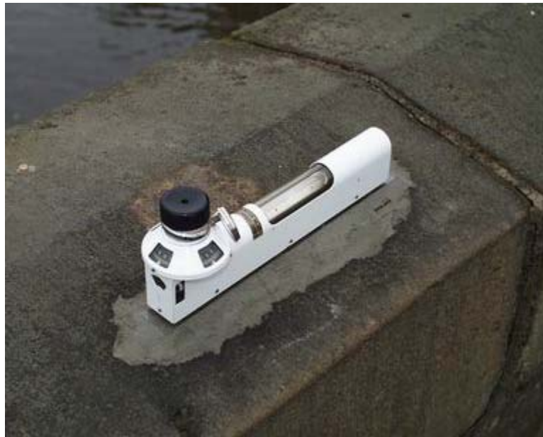
Foto 3: Kompensační vteřinový náklonoměr při odečtu podélného náklonu
