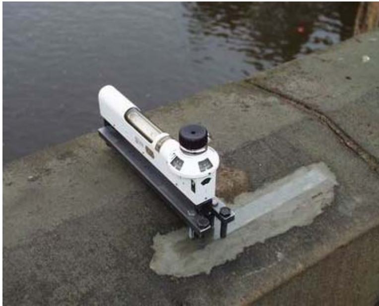
Foto 6: Odečet příčného náklonu parapetu
