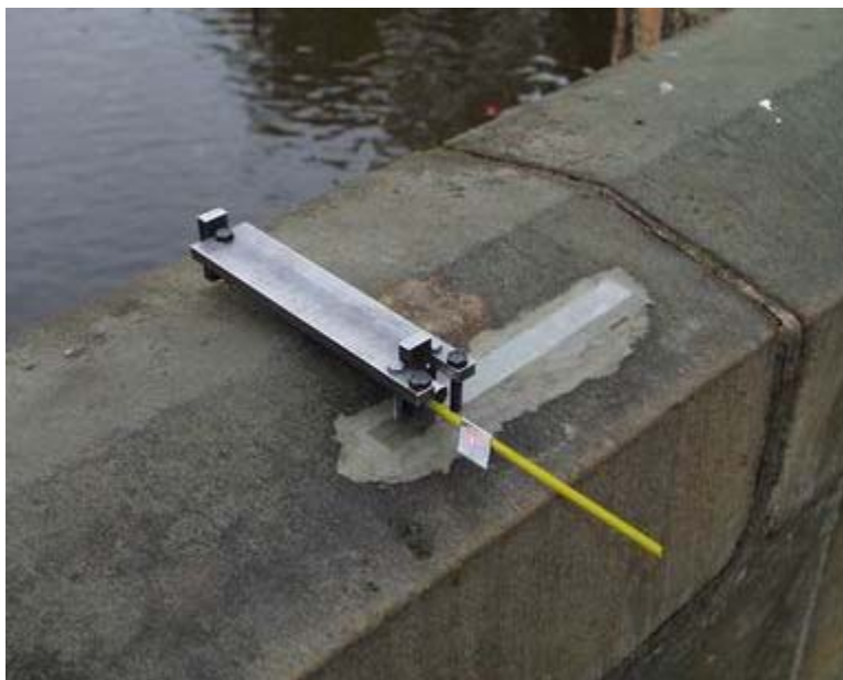
Foto 4: Přípravek pro laserový odečet příčného vybočení
