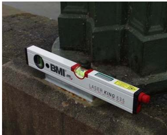
Foto 1: Laserová vodováha v poloze pro odečet svislých průhybů magneticky přichycená na prizma
