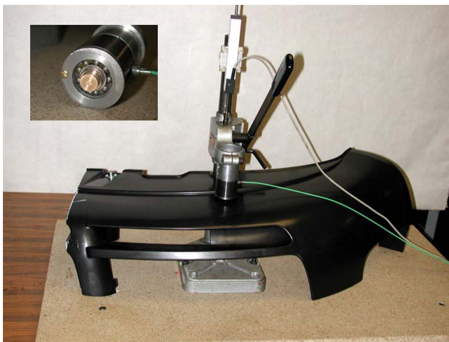
Obr. 3 – Přípravek pro měření subjektivní tuhosti plastových panelů za různých teplot
