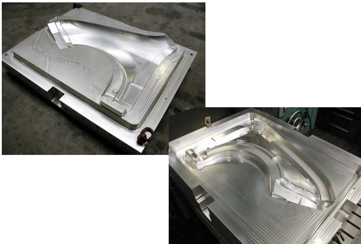
Obr. 5 – Pokusná vstřikovací forma vyrobená v Nástrojárně Peguform
