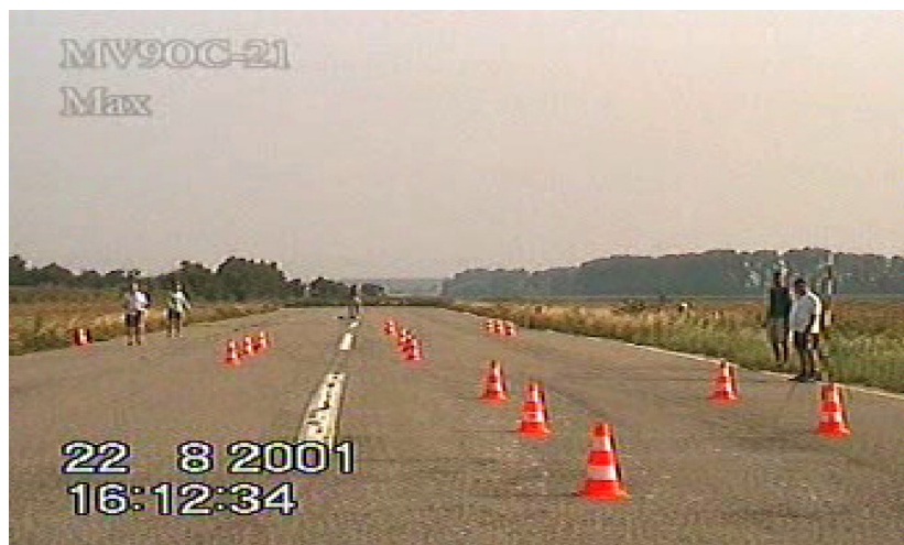
Obr. 3: Pohled na konkrétní zkušební dráhu, kužely rozestaveny podle návrhu normy ISO/WD 3888/2
