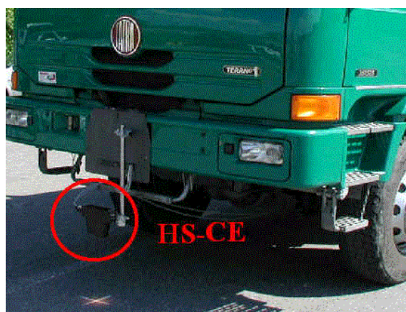
Obr. 3: Snímač HS-CE umístěný na vozidle Tatra TERRNOI.
