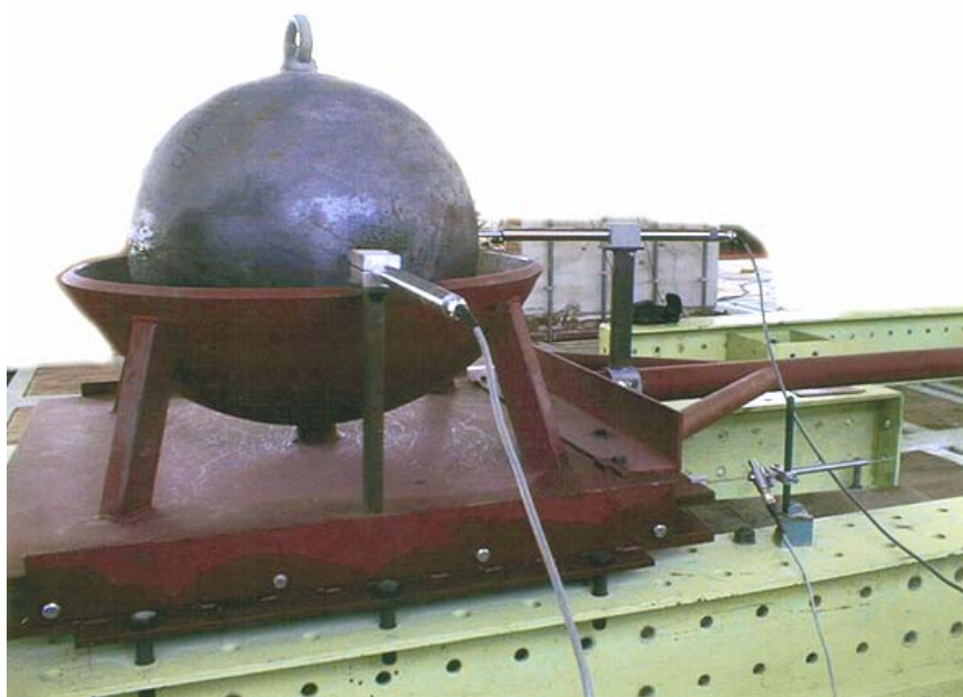
Obr. 6 - Prototyp pohlcovače z TV věže na standu ve zkušebně ÚTAM
