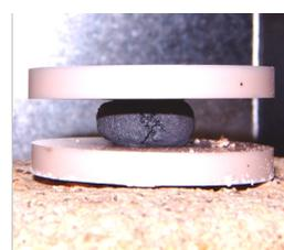
Foto 2: zkušební vzorek po pēchovací zkoušce  $T = 1405 \text{ }^\circ\text{C}$
