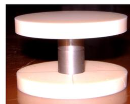
Foto 1: zkušební vzorek mezi korundovými disky
