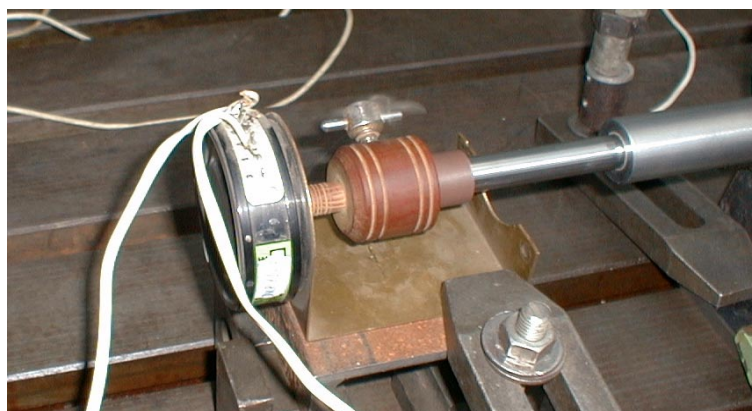
Obr. 5 Víceotáčkový potenciometr „ARIPOT“
