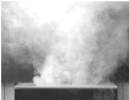
Obr. 5 Zviditelnění proudu z vyústky teplovzdušného konvektoru
