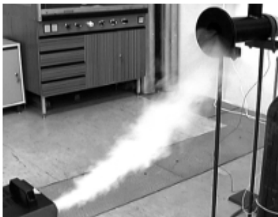
Obr. 4 Zviditelnění lokálního odsávání kruhovým otvorem s přírubou
